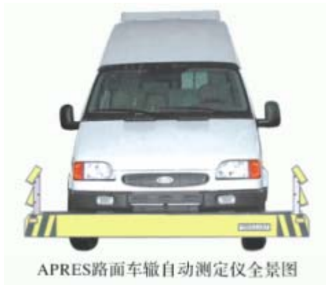
图四、多激光探头路面车辙自动测定仪（左图）及检测示意图（上图）
