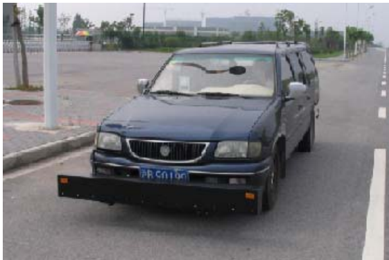
图二、激光平整度仪的系统原理图（上图）和外形照片（左图）
